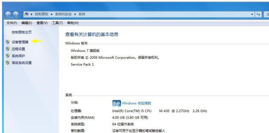
2 主板断电后，按住升级按键，USB 线接到主板 OTG 口，电脑设备管理器会有一个未知设备，右键 ~ “更新驱动”
